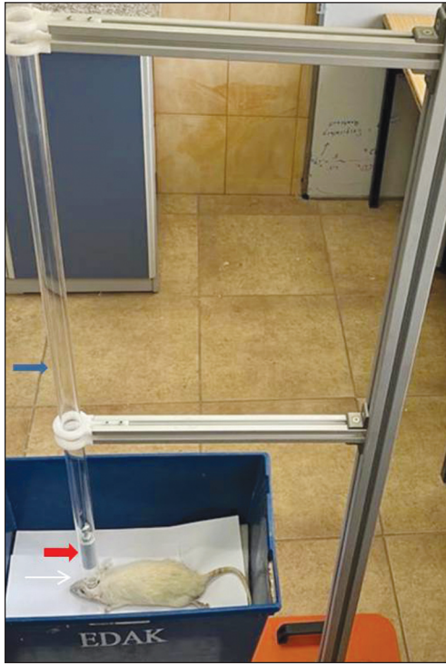
RESİM 1: Yazarın kafa travması çalışmalarında kullandığı ağırlık düşürme sistemi. Mavi ok: İç çapı 20 mm, dış çapı 25 mm olan cam boru, Kırmızı ok: 300-450 gr arasında değişkenlik gösteren çelik ağırlık, Beyaz ok: Kask olarak kullanılan 2 mm kalınlığında çelik disk.
